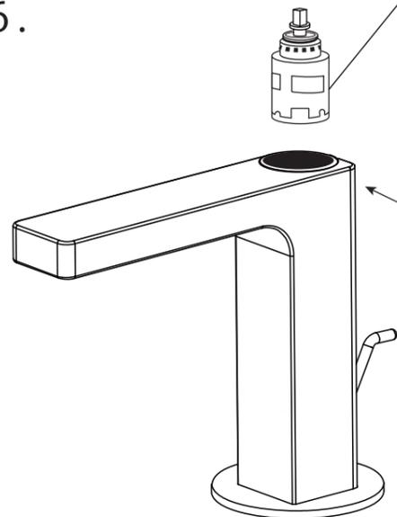
※注※ バルブカートリッジ底面にあるバルブガイド(突起)を本体側のガイド穴に差し込むようにバルブカートリッジを組付けてください。
